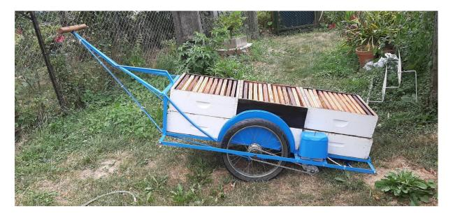
Je l'ai donc électrifiée avec un moteur de 12V/24v/36v de 350 Watts avec une batterie plomb de 12V 12Ah à recharge solaire.
