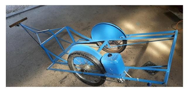
L'axe de guidage est formé à partir d'une barre en T de 20 mm et renforcée latéralement par du tube carré de 15 mm. La poignée est en buis, résistant et lisse sur la peau, traité à la cire d'abeille.
