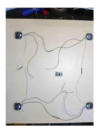
Les fils des capteurs sont connectés au HX 711 selon le schéma ci-dessous. A la phase de calibration, prévoir un facteur de correction plutôt vers 20500 à corriger dans le programme. La seule difficulté
